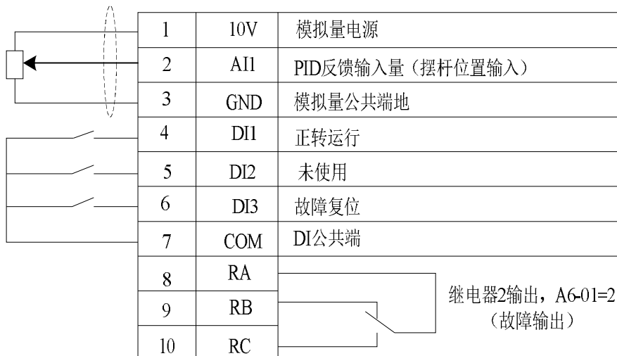
图 5.1 张力收卷接线示意图
